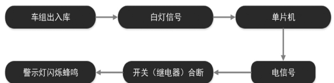
图3 智能化库内调车警示装置原理
