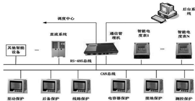
图 1 基于 DSP 的变电站自动化结构
