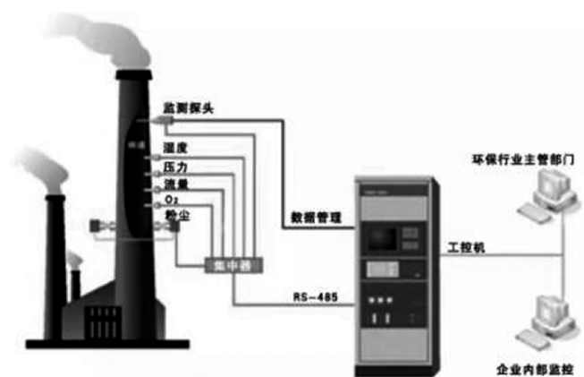
图1 在线监测系统应用流程示意图
